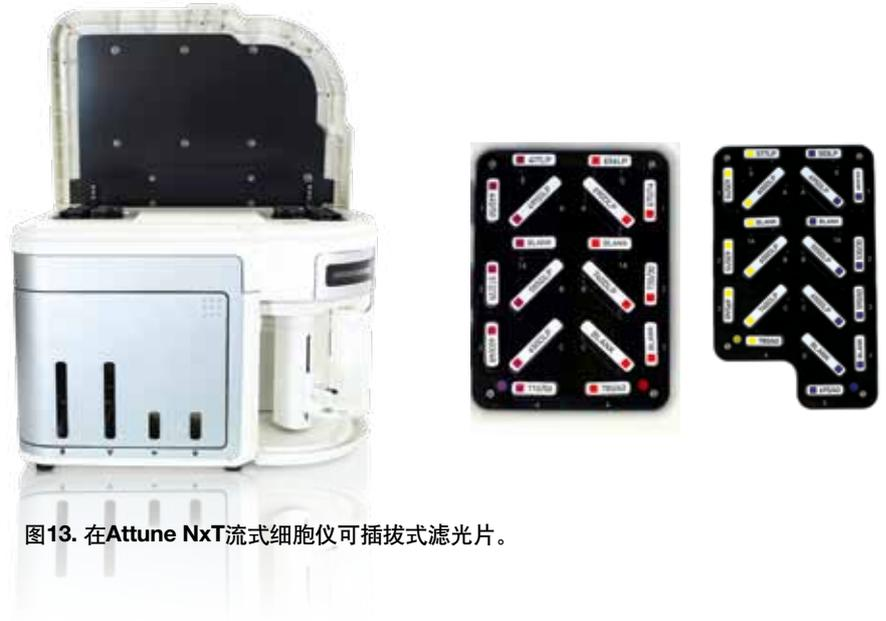
图13. 在Attune NxT流式细胞仪可插拔式滤光片。
