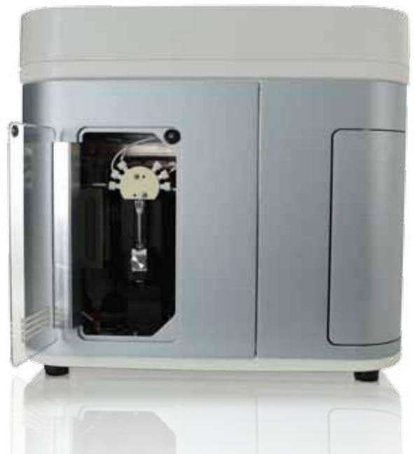
图12. 正向位移注射泵。
