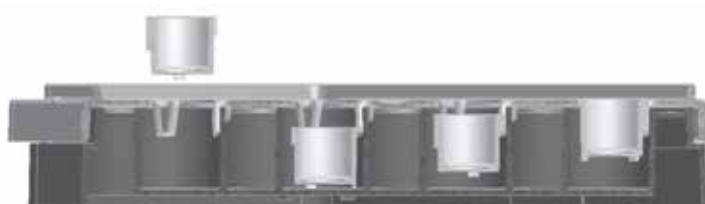
图4.Nunc载板中，Nunc插入式细胞培养器在3个悬挂位置时的横截面视图。
